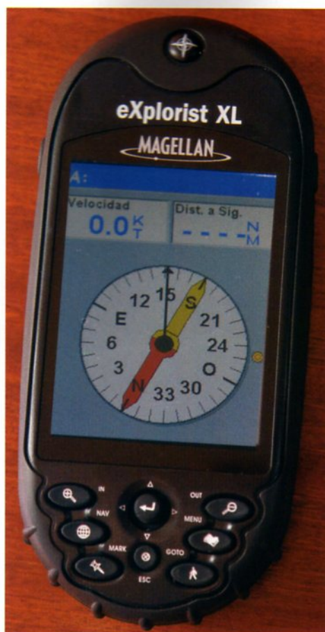
La pantalla Brújula hace las veces de compás y es muy útil para seguir un rumbo fijo.
